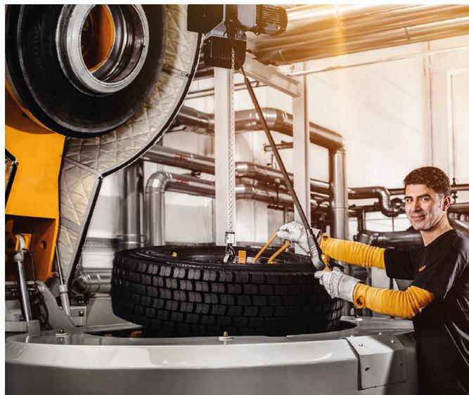
**Recauchutado en caliente.** En este proceso, similar a la fabricación de un neumático nuevo, **el dibujo de la banda de rodadura se forma durante el proceso de vulcanización a una temperatura de unos 150 °C**.
