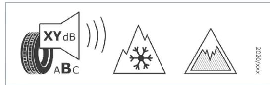
Neumático (solo Clase 1) que ha superado tanto el ensayo de adherencia en nieve como el de adherencia en hielo.
