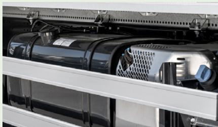
logías en los sistemas de postratamiento de los gases de escape, que pueden incluir “calentadores”, que mantengan de forma constante niveles altos de temperatura, de entre 200 y 250°C, en el interior de los módulos que albergan los catalizadores SCR, incluso nada más arrancar el motor.
