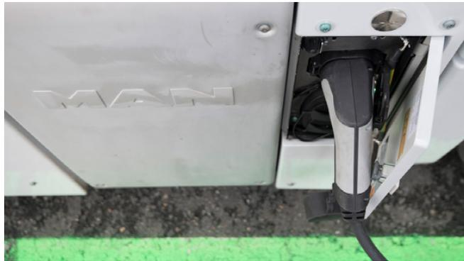
Con un sistema de carga lenta con corriente alterna (CA) de 22 kW el paquete de baterías del MAN eTGM necesita unas ocho horas para completar la carga; con 150 kW de corriente continua (CC) la carga se completa aproximadamente en una hora.
