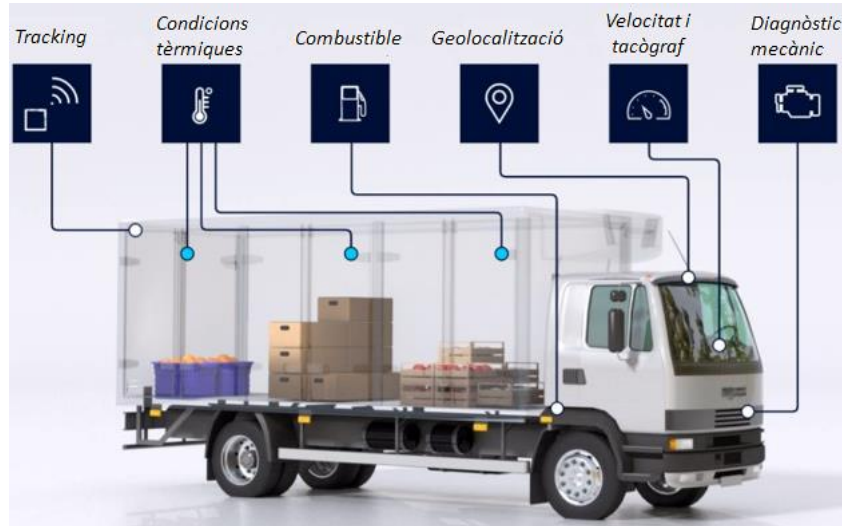
Figura 8. Exemples de sensors intel·ligents que es poden instal·lar en un camió de distribució . Font: IoTCommunity.com
